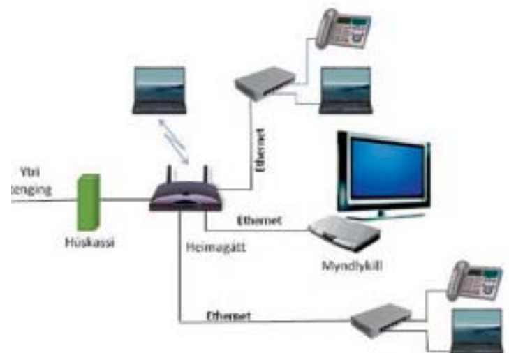
Mynd 1. Dæmigert heimanet með IP-sjónvarpi, og Ethernet tengingum.
