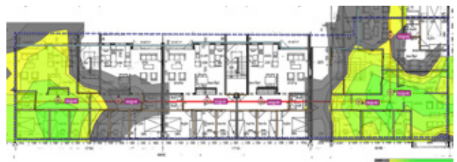
Mynd 6 – útsendingasvið frá aðgangsstöðum í nýja kerfinu á 5 GHz.
